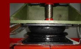
Teste de carga dos isoladores de vibração
