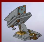
Prisma dentro da ISB, onde também se observa o espelho direcionador do SIFS
