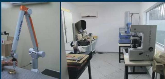
Laboratório de Metrologia Mecânica. Possui equipamentos de medida para certificar peças mecânicas confeccionadas nas Oficinas. Principais equipamentos: Durômetro Durotwin Mitutoyo; Projetor de Perfil Mitutoyo PH-350; Metrologia de Contato QM-Measure Mitutoyo; Braço Medição 3D Metris
