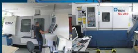
Oficina Mecânica de Precisão. Capaz de confeccionar peças com precisão de  $\pm 0,01\text{mm}$  para pequenas peças,  $\pm 0,05$  para peças de médio porte e  $\pm 0,10\text{mm}$  para peças grandes, precisões essenciais para projetos optomecânicos. Possui máquinas controladas por computador (CNC): dois centros de usinagem e um torno.
