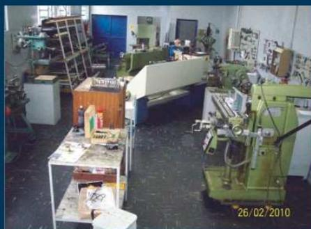
Oficina Mecânica do OPD. Responsável pela manutenção dos telescópios do OPD. Suas limitações para fresamento e torneamento são de  $\pm 0,03\text{mm}$  para peças pequenas,  $\pm 0,10\text{mm}$  para peças médias e  $\pm 0,20\text{mm}$  para peças grandes. Todas as máquinas desta oficina são manuais.
