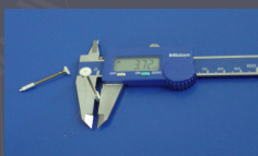
Detalhe do tamanho do posicionador cuja ponta que sustenta a fibra é construída com composto especial.
