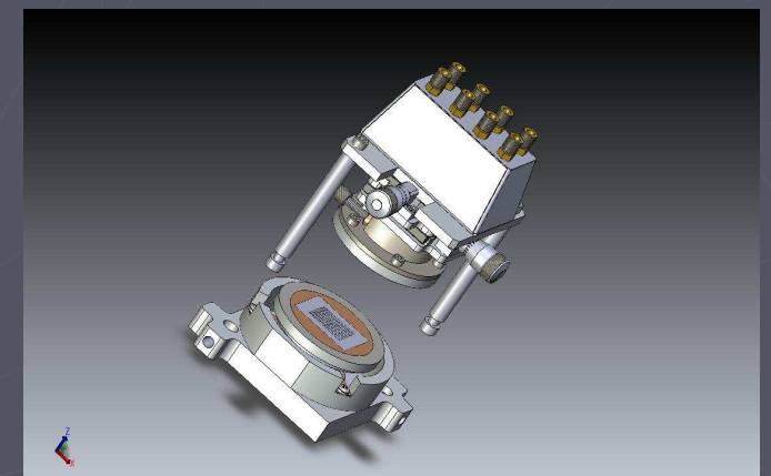
Desenho em SolidWorks do conector multifibras para 800 fibras ópticas
