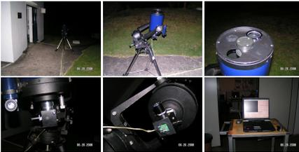
↑ Figura 2 - Montagem de teste de monitoramento de seeing ao lado do prédio do telescópio B&C 0.6m, no OPD. Foi utilizado um telescópio Meade de 20 cm (em cima, no centro), com máscara frontal de duas aberturas (em cima, à direita) e uma webcam CMOS acoplada ao foco (embaixo à esquerda e centro). A aquisição foi efetuada por um laptop com o software desenvolvido por Cavadore.
