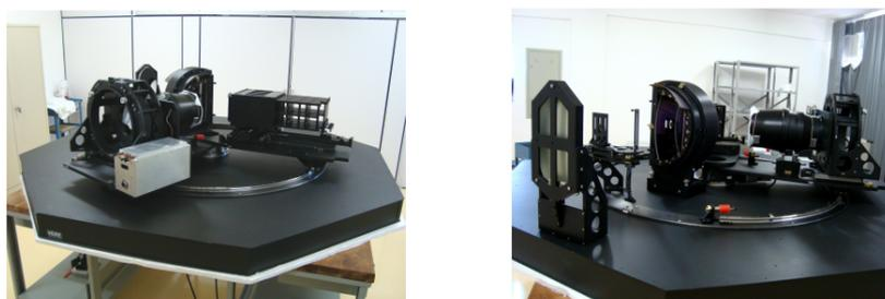
Espectrógrafo de bancada SIFS.
