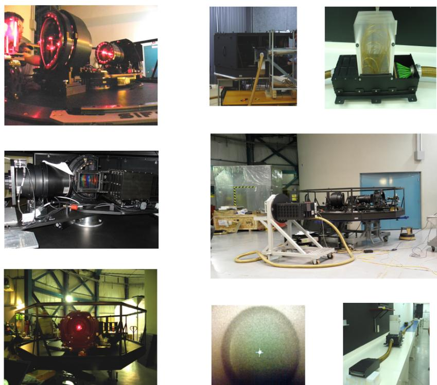
Alinhamento óptico do SIFS; câmera, colimador e fibras ópticas.
