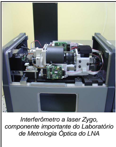
*Interferômetro a laser Zygo, componente importante do Laboratório de Metrologia Óptica do LNA*
